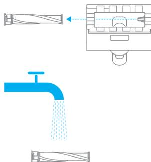
3. После промывки тщательно высушите роликовую щетку в вертикальном положении в хорошо проветриваемом месте как минимум в течение 24 часов.
