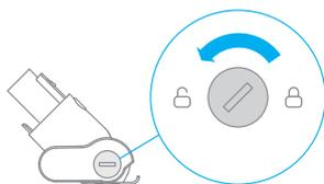
2. После разблокировки снимите роликовую насадку с щетки, а затем промойте и прочистите.
