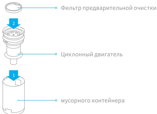
2. Защелкните зажимы по краям контейнера для пыли на ограничивающем выступе основного устройства и вставьте контейнер в основное устройство, слегка нажав на него. Клацающий звук указывает на успешную установку.
