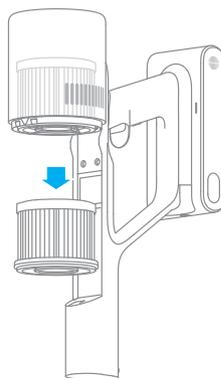
3. Промойте фильтр HEPA чистой водой, поворачивая фильтр на 360°, чтобы полностью удалить накопившуюся в нем пыль. Несколько раз слегка постучите по фильтру, чтобы убрать избыток грязи.
