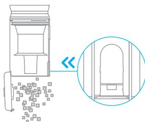
Способ 2. Зажмите верхнюю крышку мусорного контейнера и снимите циклонный блок.
