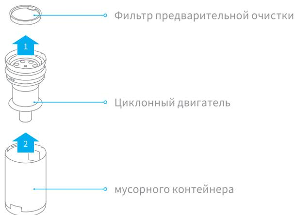
4. Тщательно промойте фильтр предварительной очистки, циклонный блок и контейнер для пыли водой, а затем отложите минимум на 24 часа для полной просушки.
