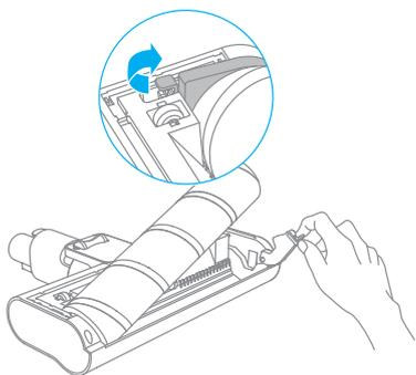
2. Используйте ножницы, чтобы отрезать волосы и волокна, которые прилипают к головке щетки. Вытрите пыль из выемки и прозрачной крышки сухой тканью или бумажным полотенцем.
